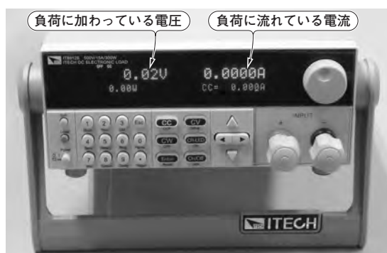
写真1 メーカー製の電子負荷は温度を測れないのが物足りない引き込む電流値を調節できるプログラマブルな負荷。電池の出力特性の評価や半導体の温度上昇テストに利用できる。電流の引き込みも吐き出しもできて精度も高いが、肝心の温度を測る機能をもったタイプが見当たらない
