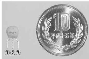
写真3-1 セラミック発振子 CSTLS20M0(村田製作所)の外観
