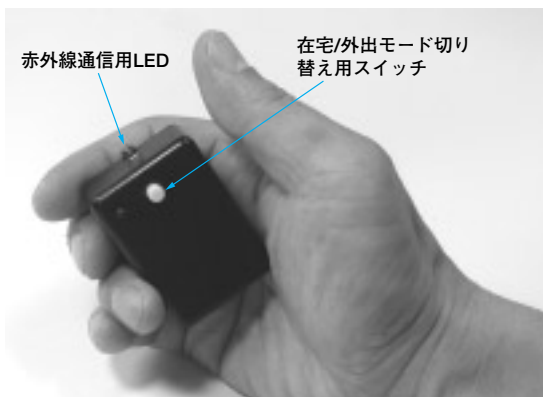
(b) 4入力モニタ付き警報装置を操作するリモコン
