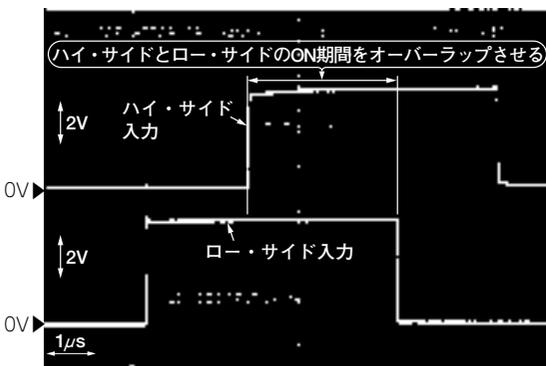
写真3 ゲート・ドライバFAN7380の貫通電流抑止回路の動作
