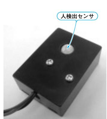
写真8-1 製作した制御BOXとセンサBOX
