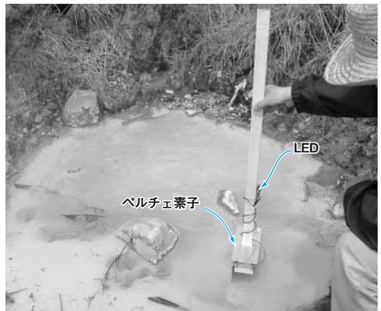
写真13-3 地熱で高輝度LEDを点灯させてみる
