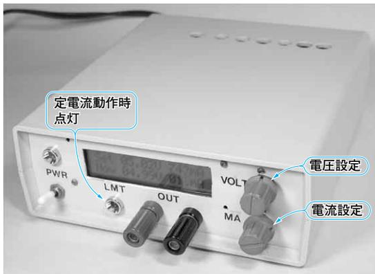
写真5-1 製作した実験用の定電圧定電流電源
