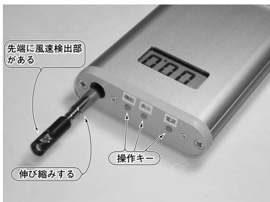
写真1 製作した風速計の外観
