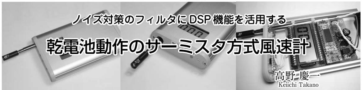
温度検知素子として広く使用されているサーミスタを、風速センサとして使った風速計を製作しました。発熱体が風によって冷却されることを利用します。
