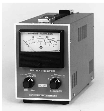
写真6-1 終端型電力計 WD-201(クラニシ)の外観 周波数：1.8 M～1300 MHz、電力：5/20/200 W 切り替え、インピーダンス：50 Ω、SWR：1.2 以下、ダイオード検波方式
