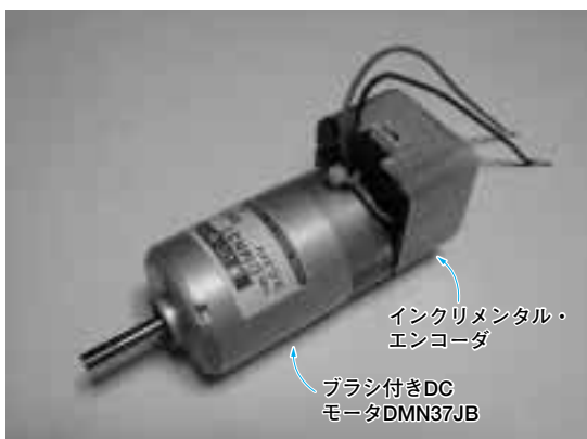
写真 6-2 ブラシ付き DC モータにインクリメンタル・エンコーダを取り付けた DMN37JEB の外観
