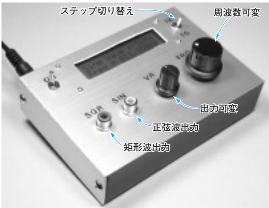
写真6-1 製作した低周波発振器の外観
