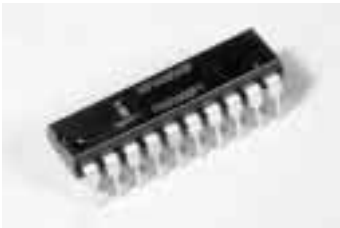
写真1 フル・ブリッジ専用のドライブIC HIP4080A 負荷容量1000pFでスイッチング周波数1MHzを保証している。D級オーディオ・アンプ向き
