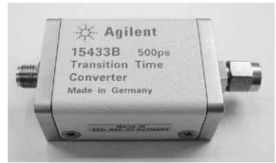
写真11-1 トランジション・タイム・コンバータの外観 両端はSMAコネクタとなっている
