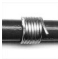
写真8-1 製作したソレノイド・コイルの外観
