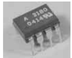
写真1 150 A、1200 V クラスの大電力パワー・デバイスも駆動できる HCPL-316J (アバゴ・テクノロジー)
