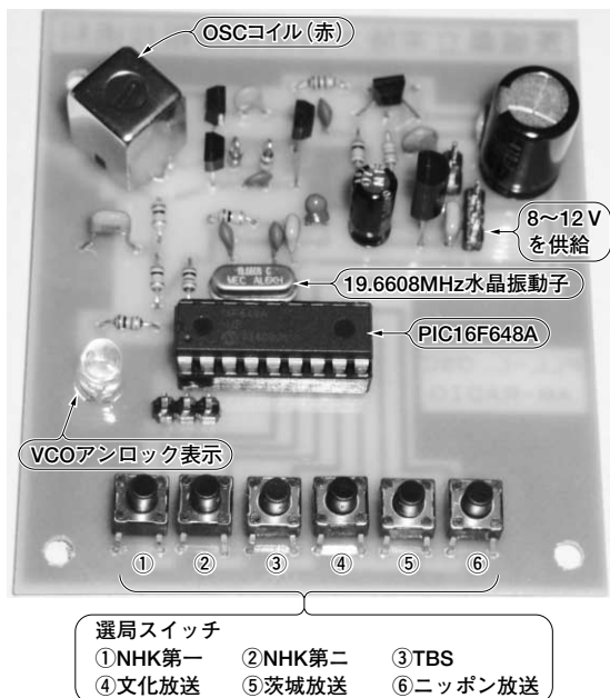
写真1 PICマイコンで位相比較器を作りAMラジオ用の局部発振器を製作
