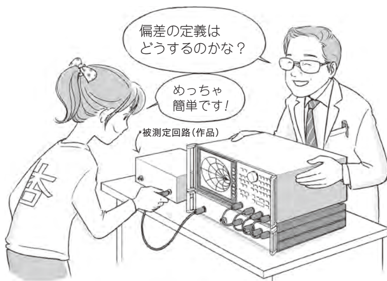
〈図1〉製作した回路の入力インピーダンスを測定する
