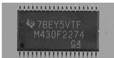
写真1 MSP430F2274 の外観 OP アンプを二つ内蔵している
