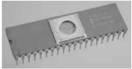
写真9-2 8051の内蔵ROMをUVEEPROMにした8751(インテル)の外観
