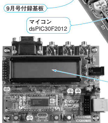
写真1 次号(9月号)の付録基板に部品を搭載した dsPIC マイコン実験ボード(完成状態)
