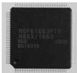
写真1 USB インターフェースを内蔵する 32ビット・ワンチップ・マイコン H8SX/1653 〔株ルネサス テクノロジ〕
