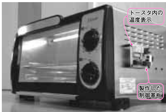
写真1 オープン・トースタで製作したリフロ装置 温度プロファイルを3種類から選択し、自宅でリフロができる
