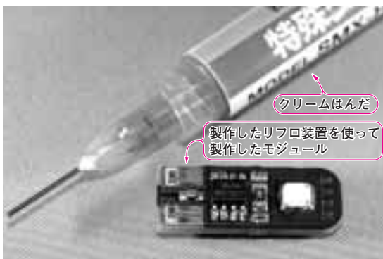
写真2 実装見本の基板と使用したクリームはんだ 実装見本の基板はきれいに実装できている
