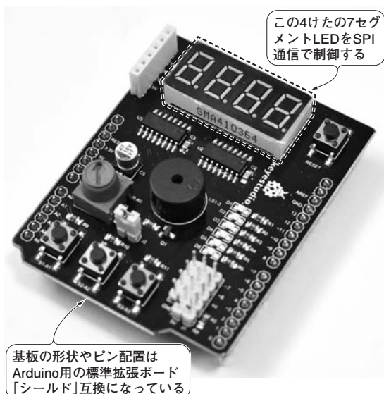
写真1 Arduino用の標準拡張基板である「シールド」と形状やピン配置が互換になっているMulti-Purpose Shield V2
