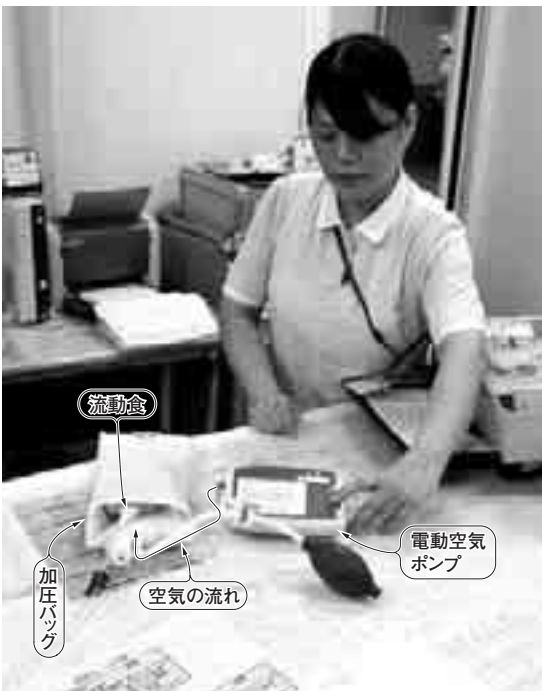
写真1 製作した電動空気ポンプを使用中の様子 介護者が加圧バッグに流動食バッグをセットし、加圧開始。介護福祉士さんの負担を軽減できた
