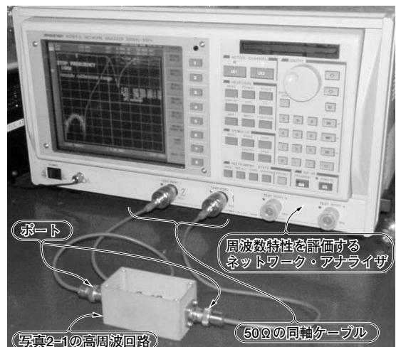
写真2-2 実際の高周波回路を評価するときは同軸コネクタと同軸ケーブルを介して測定器に接続する
