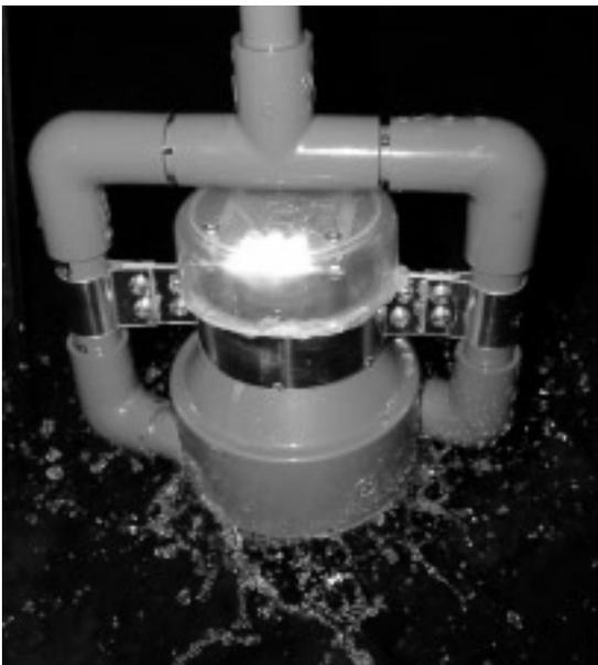
写真7-1 水道水の圧力で高輝度LEDを点灯する
