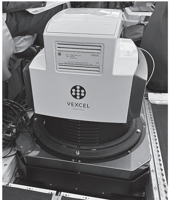
写真2 なんと5億画素…高精細化がすすむ測量用航空カメラ Ultra Cam Eagle 4.1 (VEXCEL社) は対地高度2500mから2.9km×1.8kmの範囲を、地上画素寸法10cmで撮影可能
