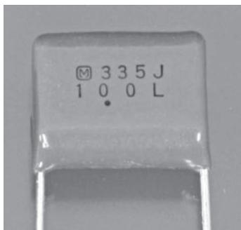
写真2 使用したフィルム・コンデンサ
