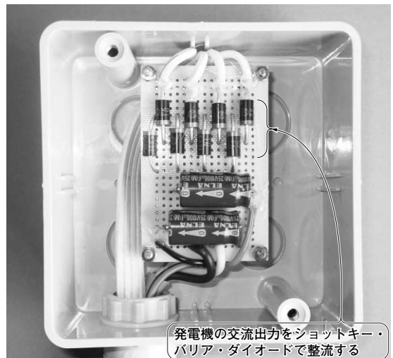
写真3 発電機の整流回路基板 水車に設置するので防水ケースに収納した
