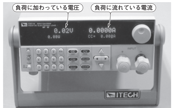
写真1 メーカー製の電子負荷は温度を測れないのが物足りない引き込み電流値を調節できるプログラマブルな負荷。電池の出力特性の評価や半導体の温度上昇テストに利用できる。電流の引き込みも吐き出しもできて精度も高いが、肝心の温度を測る機能をもったタイプが見当たらない
