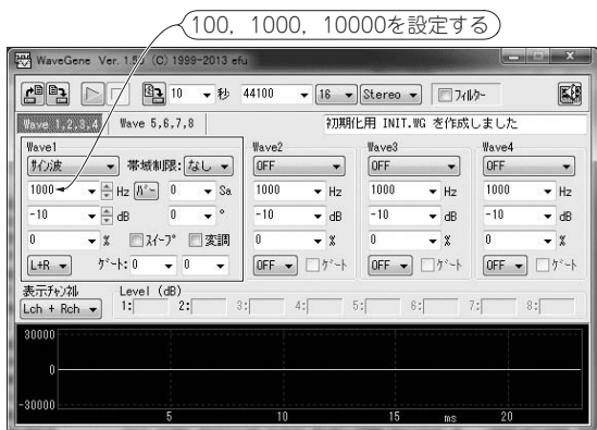
図1 フリーの信号発生アプリケーションWaveGeneを利用する通常Wave1のところを使う。ここに、100 Hz, 1000 Hz, 10000 Hzをそれぞれ設定して発振させる
