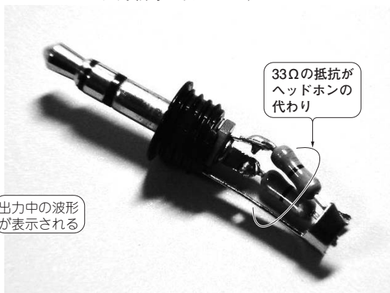
写真1 ヘッドホンを模擬する測定治具
