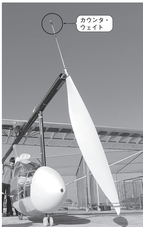
写真2 独特な形の1枚ブレード・プロペラ プロペラの反対側にカウンタ・ウェイトという重りが付いており、特定の回転数で振動を抑えられる
