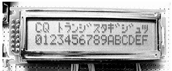
写真1 キャラクタ・ディスプレイ・モジュール SC1602Bの外観 (Sunlike Display Tech. Corp.)
