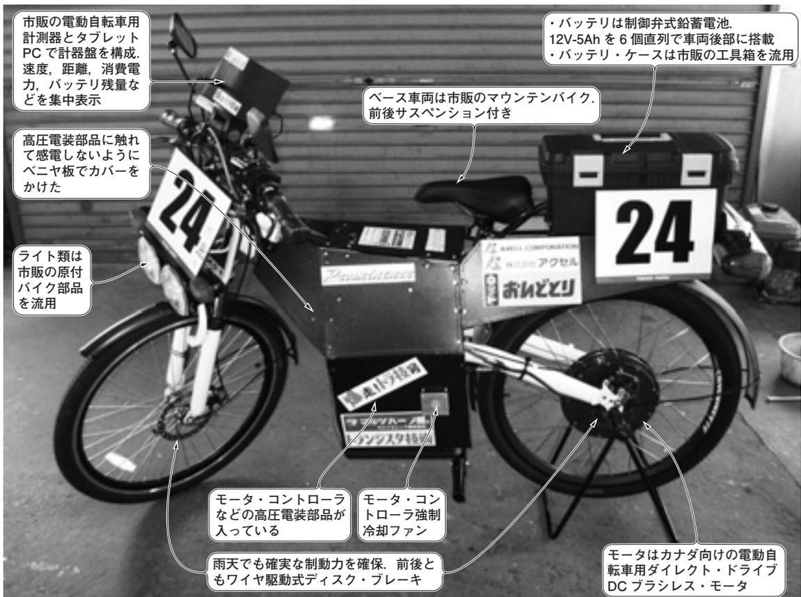
写真1 個人でも1個から入手できる部品だけで作れる電動バイク「爆走! トラ技号」
