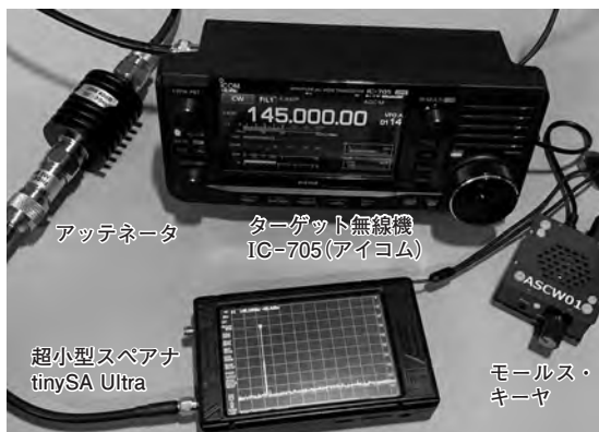
〈写真1〉実力確認！超小型スペアナtinySA Ultraで無線機の試験項目を測ってみる
