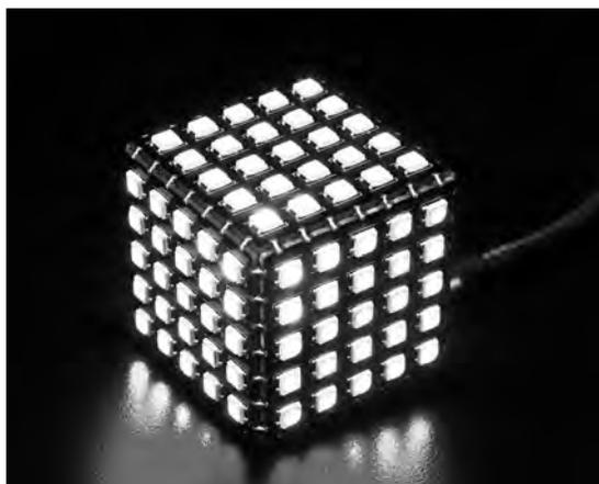
写真1 超コンパクトとケースいらずを追及して製作したサイコロ型LEDマトリクス
