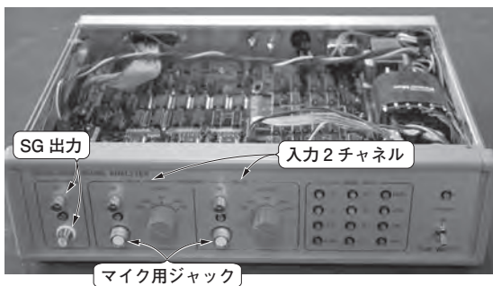
写真1 FFTアナライザのハードウェア例 室内音響測定に使うことを考慮しつつ汎用で作ったFFTアナライザのアナログ・フロントエンドで、FFT解析はUSB接続したパソコン上で行う
