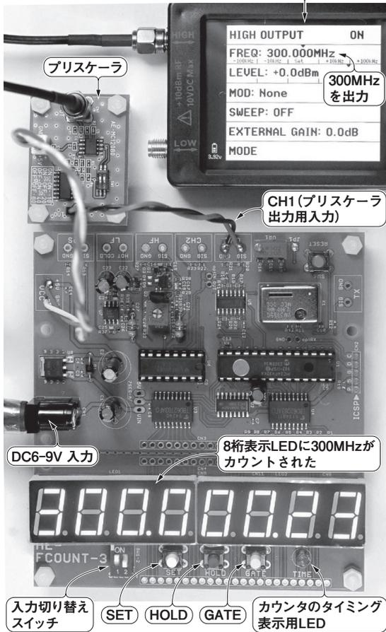
写真1 数十MHz~GHzを測れる周波数カウンタを製作して300MHz信号を測ってみた
