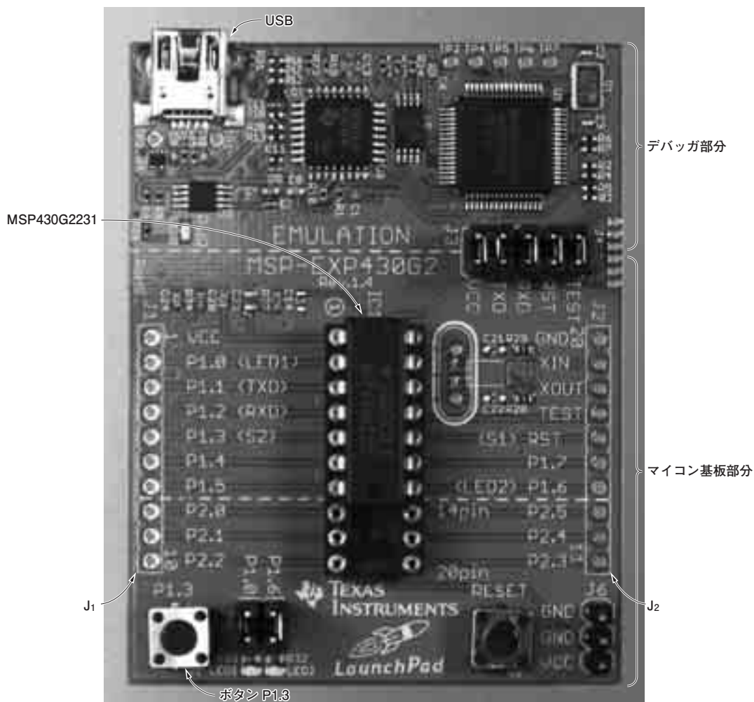
写真1 超低価格(US$4.3)MSP430評価ボードLaunchPadの外観
