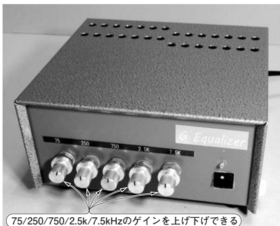
写真1 5バンド・ステレオ・グラフィック・イコライザを製作 それぞれの周波数の調整範囲は \pm 20 dB
