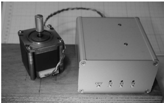
写真1 レコード・プレーヤのターン・テーブル用駆動装置を製作した
