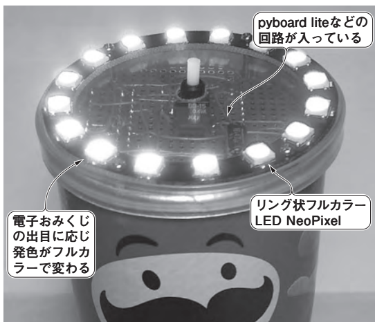
(b) おみくじの出目に応じて光ったりしゃべったりするプログラムを MicroPython で
