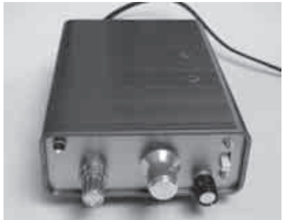
写真3 試作した出力インピーダンス可変型のパワー・アンプワンチップのパワー・アンプICを利用してコンパクトに仕上げた
