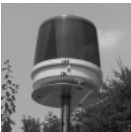
写真5-1<sup>(5)</sup> 製作したMPPT搭載充電回路を内蔵した警告灯
