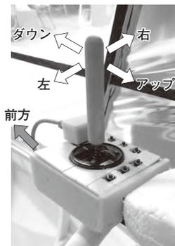
写真1 操縦桿と水平尾翼と垂直尾翼の動き
