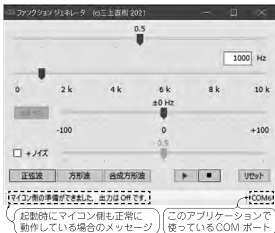
図2 PCファンクション・ジェネレータの操作画面 パソコンでプログラムを立ち上げマイコン側も正常に動作している場合の表示
