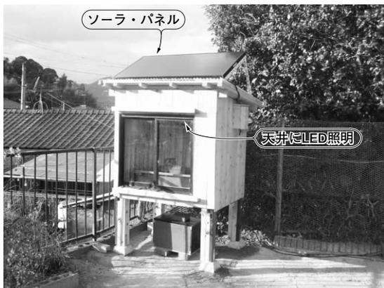
写真1-1 ソーラ・パネルを電源としたLED照明を備える育苗器を製作
