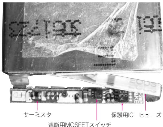
写真2 リチウム・イオン電池パックの内部
