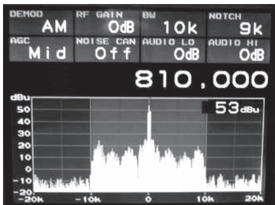
図2 実際のAM放送のスペクトラム 中心にキャリアがあり±10 kHzの帯域でLSBとUSBがある
