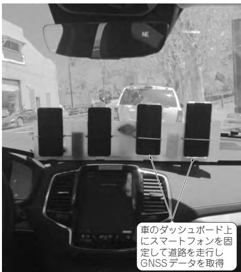
写真1 (1) 一番身近な受信機スマホのGPS/GNSS測位の高精度化を迫る競技会GSDC(海外で実施)
